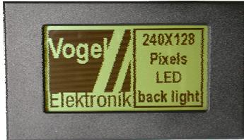
Die Kontroller sind auf die jeweiligen LCD-Module angepasst und können nicht mit anderen LCD-Modulen verwendet werden. Die Grösse des Controllers entspricht der Modulgrösse.
